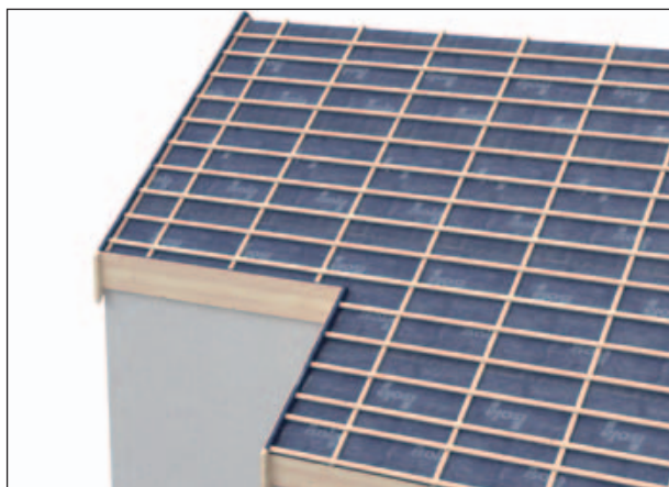
Vzdálenost latí u tašek Exclusive (Upozornění: minimální sklon střechy: \geq 8^\circ )
