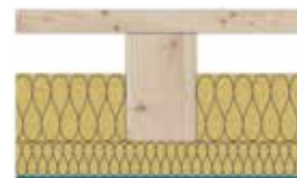
Nosné bednění pomocí kontralatí
